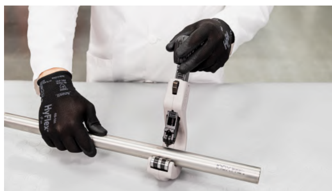
Image 19 - Mise à longueur des tubes
